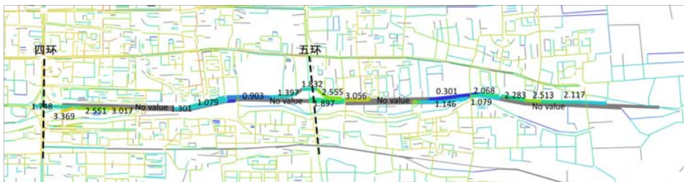
图8 北京东三环到东五环某快速路路段Depthmap模型生成的可达性 资料来源:笔者自绘。
