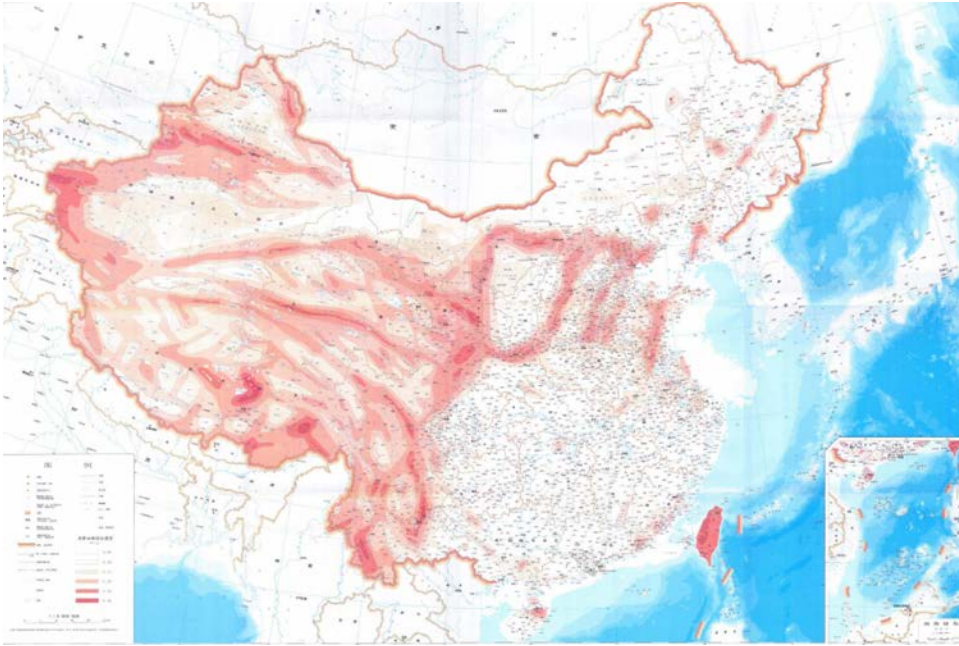
图1 中国地震动峰值加速度区划图(中国地震动参数区划图(GB18306-2015)) 资料来源:作者自绘。
