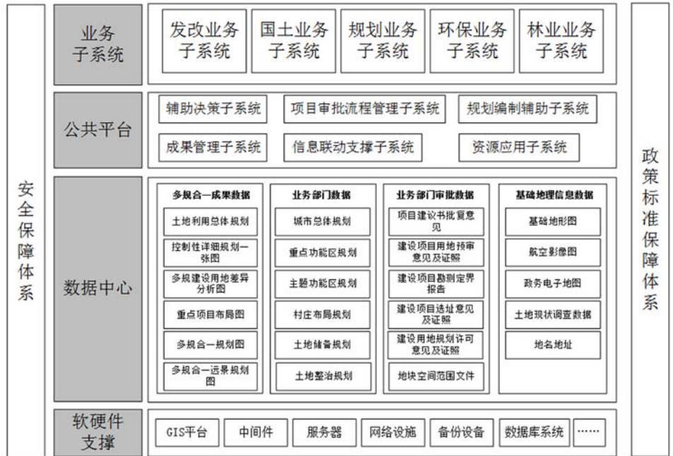
图3 贺州市多规平台框架设计图 资料来源:根据贺州市“多规合一”业务协同平台建设实施方案绘制。
