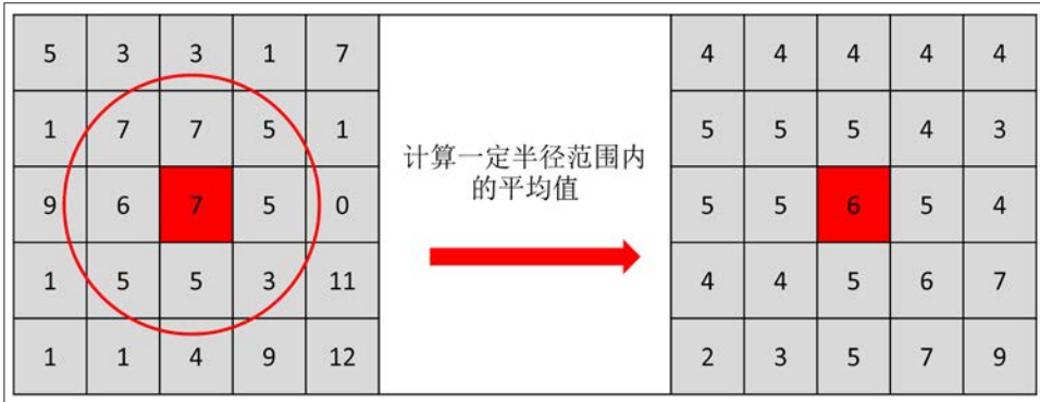
图3 焦点统计分析原理示意（以平均值为例）
