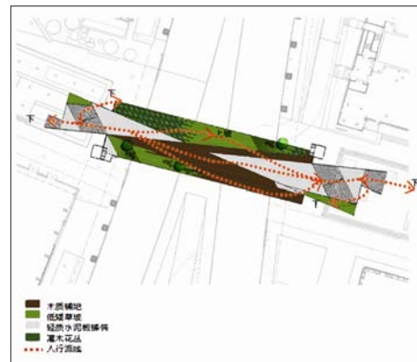
图7 分区功能的桥面铺装
