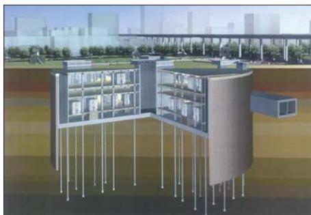
图11 世博500 kV地下变电站内部结构图
