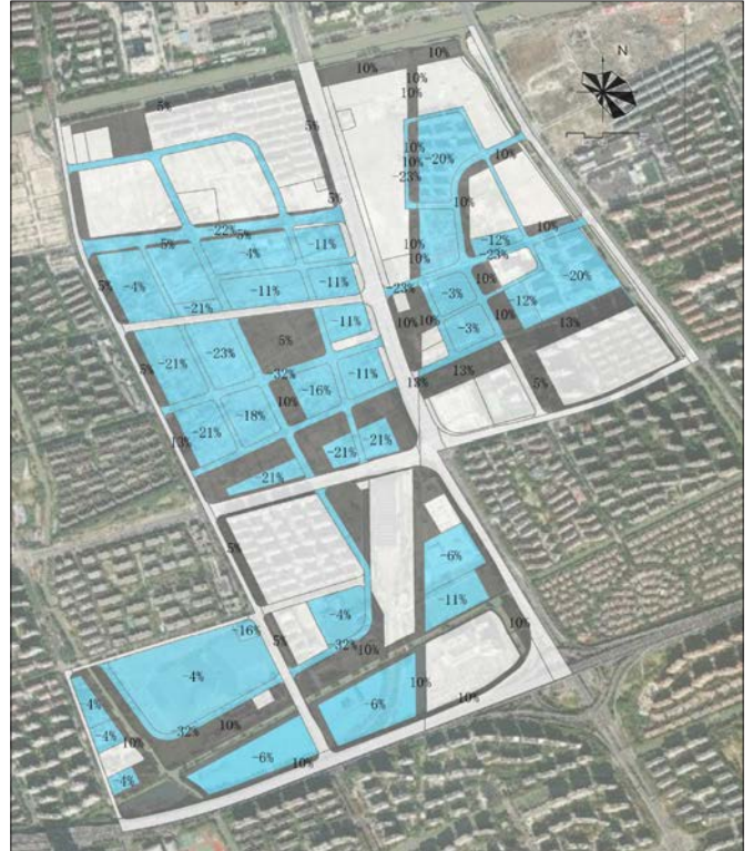
图9 浦东新区杨思地区海绵城市建设系统方案对各地块海绵城市指标（年径流总量控制率）的控制优化
