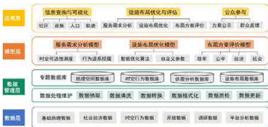
图2 公共服务设施布局规划支持系统技术架构
