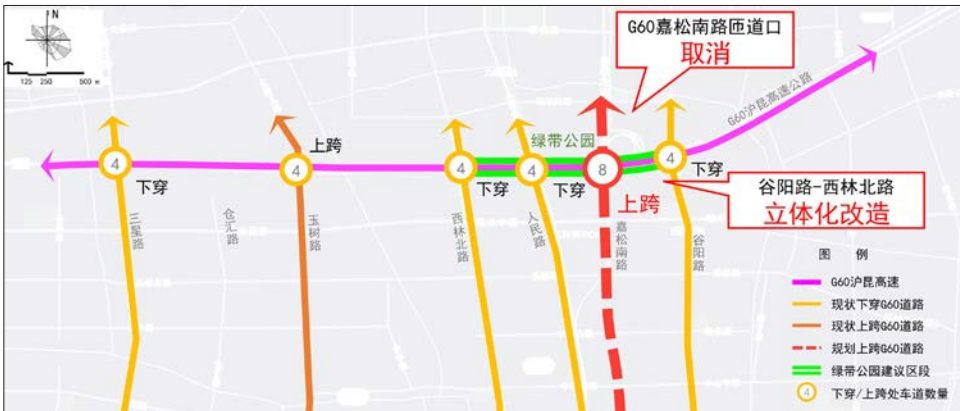
图10 G60沪昆高速(西林北路至谷阳路)立体化改造方案示意图
